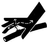
Não verifique vazamentos no circuito hidráulico com as mãos, pois a alta pressão pode provocar grave lesão.
